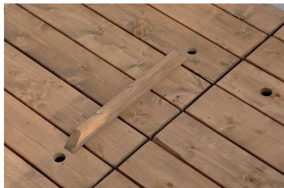
*Im Mittelschiffsbereich gibt eine Ruderbank die nötige Quersteifigkeit. Ein dreiteiliger imprägnierter Holzfußboden mit einer Fußstütze ermöglicht entspanntes Rudern.*
